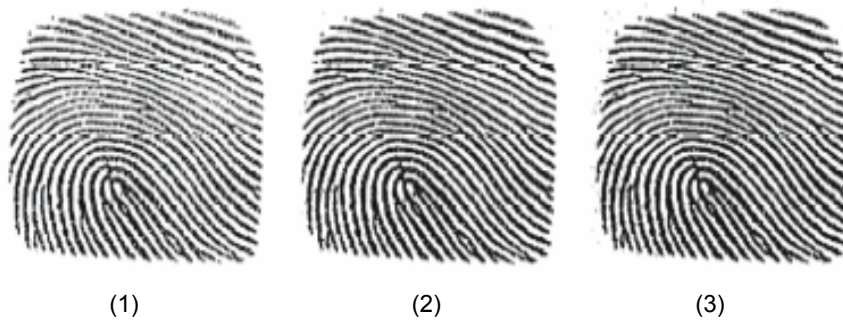
Abbildung 33: S/W-Konvertierung bei verschiedenen Grenzwerten [(1): 100 ; (2): 128 ; (3): 140]
